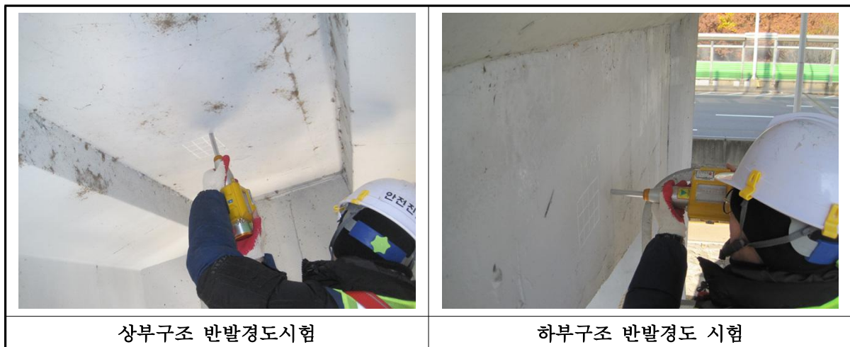
【그림 II-1.3.23】 반발경도 시험 전경
